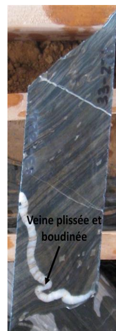
Figure 15 : Photo de l'échantillon 33-224 : déformation dans le domaine ductile
